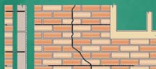
7. Opravy trhlin v blízkosti rohů a otvorů
