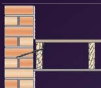
13. Připevnění stropních trámů
