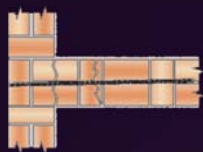
2. Stabilizování vyboulených zdí do konců trámů
