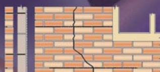
7. Opravy trhlin v blízkosti rohů a otvorů
